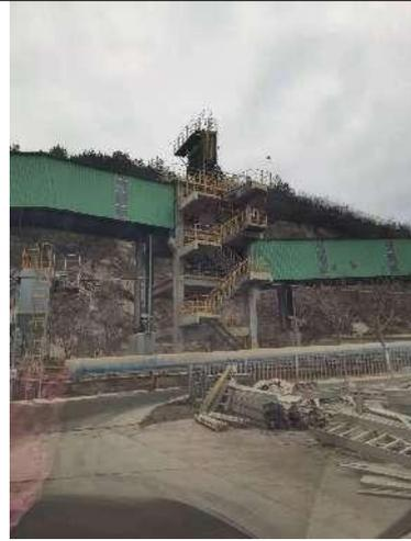
物料密封输送系统及节点除尘设备
